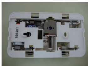
電子音ではなく、ソレノイドで金属板を叩く仕組み
