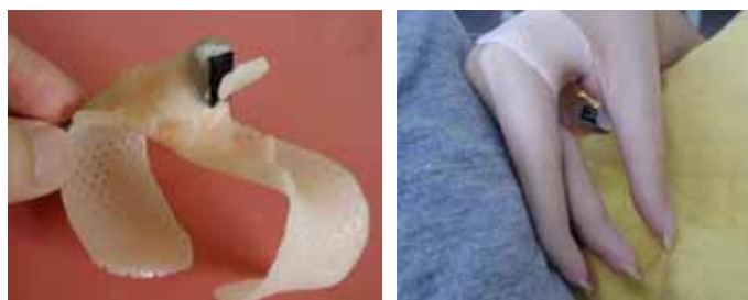
図10 マイクロスイッチを熱可塑性素材に固定
