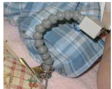
図21 スイッチの固定
