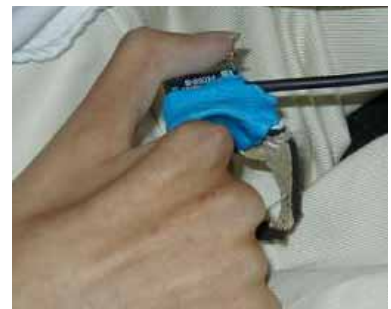
図20 スイッチの固定
