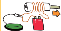
電源とスイッチを取り付け、スイッチを押すと鉄心が動く
