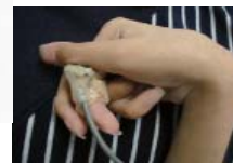
スプリント素材もスイッチを固定するのに適しているよ
