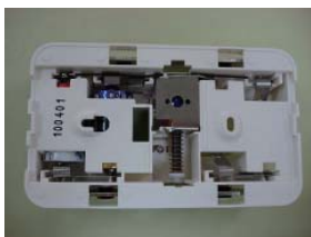
電子音ではなく、ソレノイドで金属板を叩く仕組み
