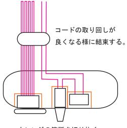
オレンジの箇所を切り抜く。 抜いたところにスイッチを埋め込む。
